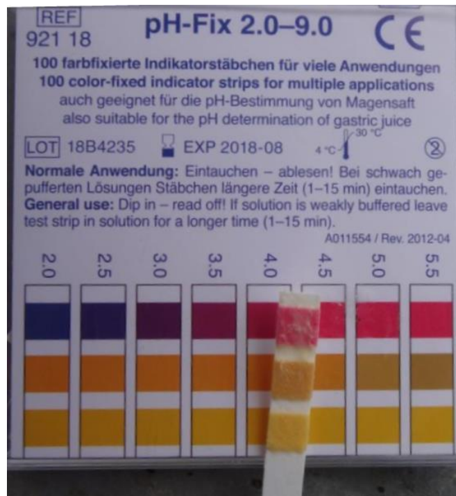
Abbildung 2: Kontrolle des pH-Werts mittels Teststreifen
